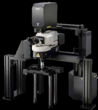
生体深部の微細構造を鮮明に可視化する多光子共焦点レーザー顕微鏡システムが、さらに進化。1回のスキャンングで広範囲にわたる動態を、圧倒的な空間分解能と時間分解能で取得します。この度、センターに新たに導入された多光子レーザー顕微鏡AX R MPのご紹介をいたします。
